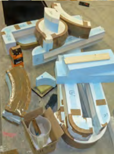
Komplexe Schalungs- teile werden manuell gefertigt
