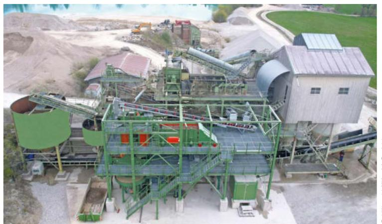
Kombination Kieswerk und Bodenaufbereitungsanlage.
