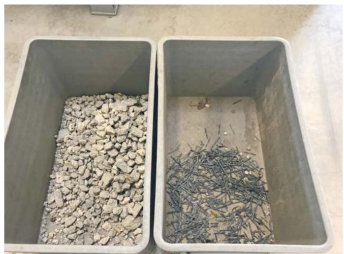
Ergebnis kamerabasierte Sortierung von Carbonbetonabbruchmaterial.
