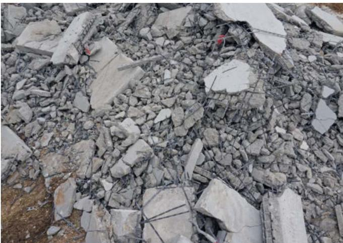
Material aus dem maschinellen Abbruch von Carbonbetonbauteilen.
