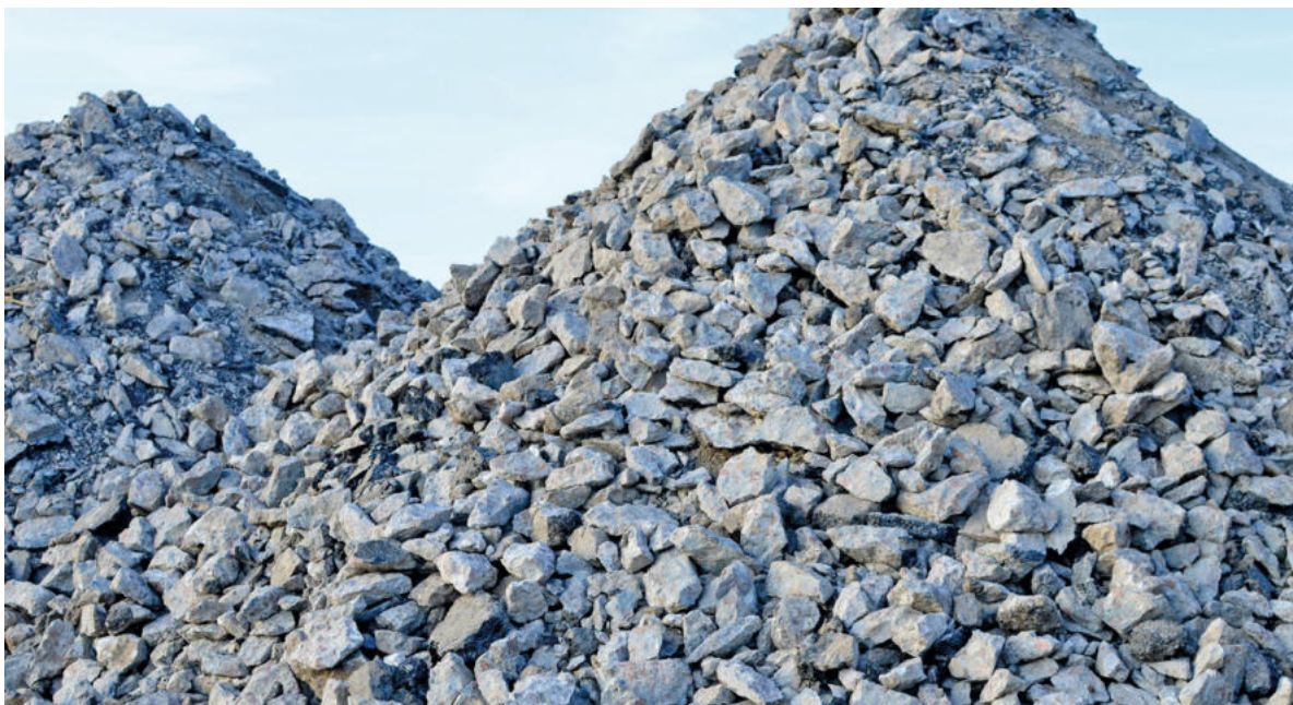
Der Bruch von Beton kann zu rezyklierter Gesteinskörnung aufbereitet werden.
